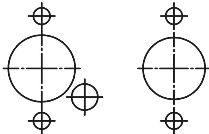
*Монтажные отверстия для отопителей Спутник-2Д, Спутник-4Д*
