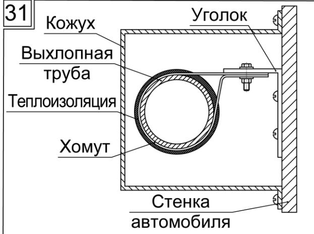
Категорически запрещается монтаж отопителя с открытым участком выхлопной трубы внутри фургона, изотермического фургона, КУНГа и других помещениях транспортного средства, в случае установки отопителя на подвесной кронштейн, как показано на рисунке 32.
