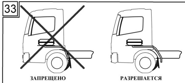
Выхлопная труба и воздухозаборник должны монтироваться только через один борт (задний, передний или боковой). При этом расстояние между ними должно быть не менее 200мм.
