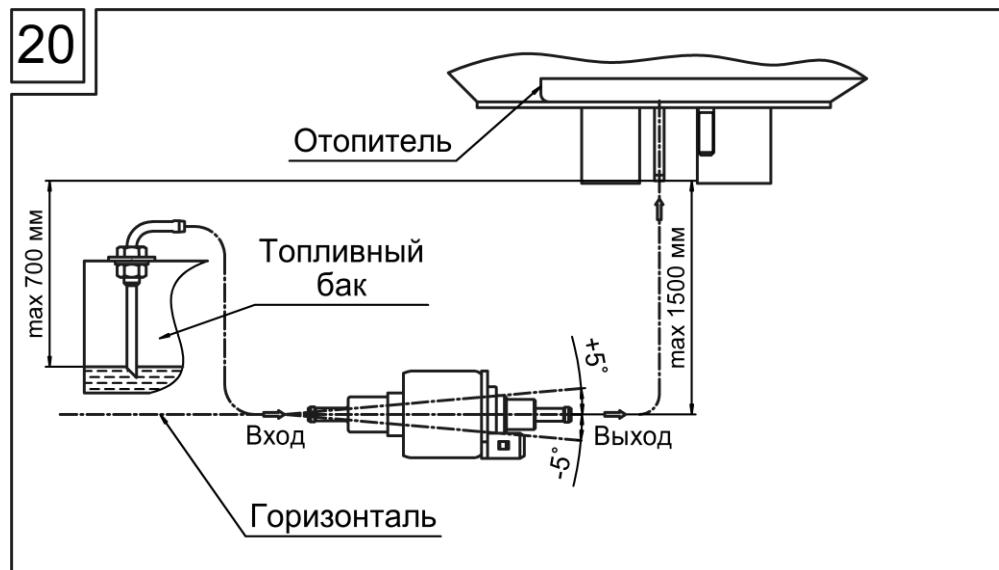
Для стабильной работы отопителя необходимо устанавливать топливный насос не далее, чем на 1000 мм от топливного бака и ниже нижнего уровня в топливном баке, как показано на рисунке 20.
