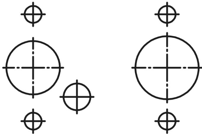
*Монтажные отверстия для отопителя Спутник-ЗЛ*
